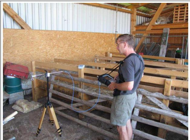
Messpunkt 1, Trapezblechseite, der Autor bei der E-Feldmessung mit eindimensionale Messantenne EFS9218 und Spektrumsanalysator FSH8.
