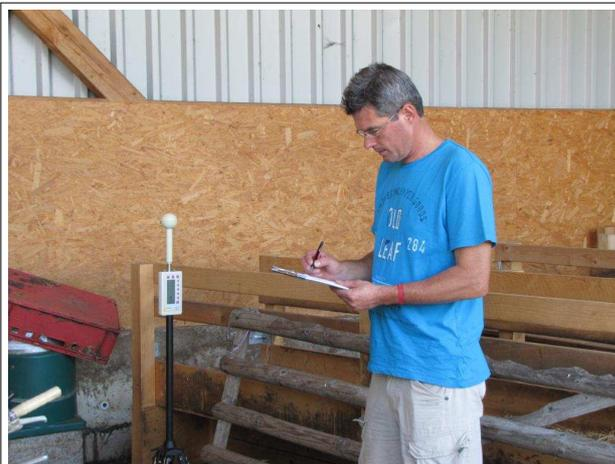
Messpunkt 1, Trapezblechseite, der Assistent beobachtet das breitbandige, dreidimensional messende E- und H- Feldmessgerät ESM100
